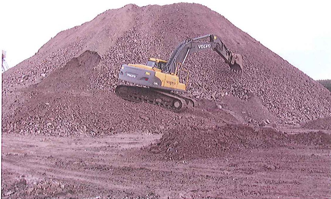
Photo no 2: Prélèvement à l'aide d'une pelle excavatrice dans l'halde de stérile.
